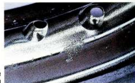
Schlechtes Beispiel: Diese Felge wurde nicht ausreichend geschliffen
